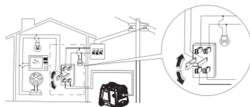
電気工事士に依頼し、電源切替開閉器を設置して屋内配線に接続する。
