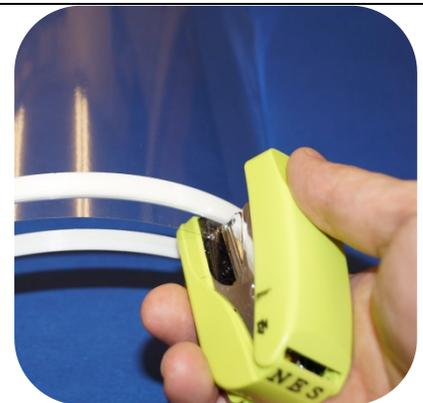
6. フィルムが脱落しないよう、飛び出した1cmの部分にステープラーを打ち込みます。
