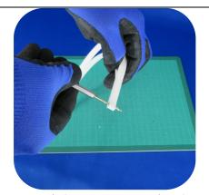
4.3mm 前後のドリルを両端の穴に 挿入し、手で回して奥へ進み不 要な物を取り除きます。
