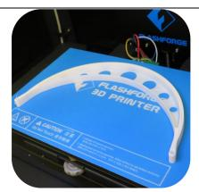
1. 造形直後は壁崩壊防止用の補助 床が付いているため、この補助 床を除去します。
